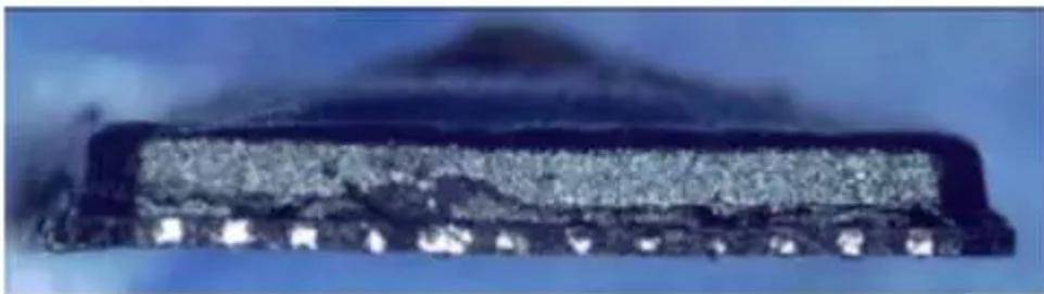
图 3. LFCSP 的低放大率侧视图显示返修设置过大引起的损伤（塑封材料鼓出）
