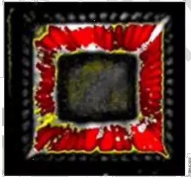
图 2. 移除不当引起 LFCSP 芯片焊盘分层（通过扫描声学显微镜观测）
