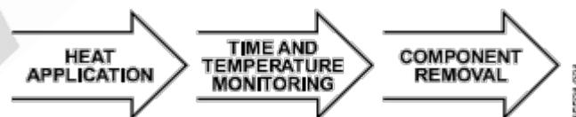
图 4. 器件移除评估的简化流程图
